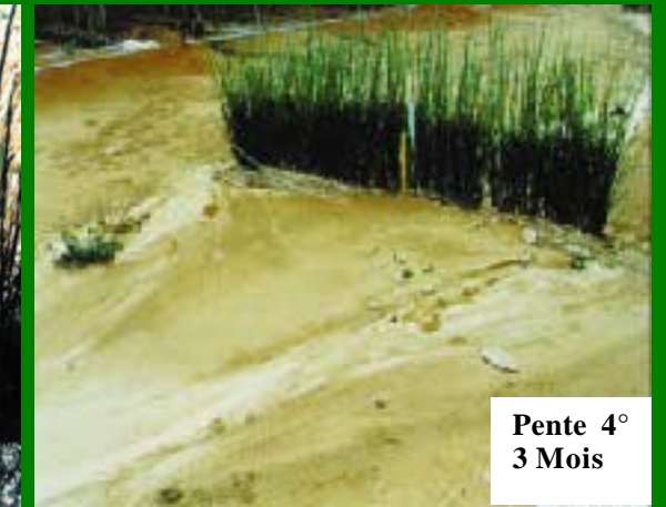
Cette haie expérimentale nous montre comment le vetiver parvient à retenir les sédiments
