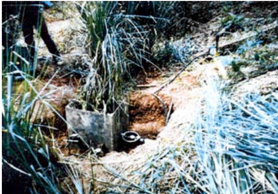
Test in situ de la résistance des racines de vétiver au cisaillement
