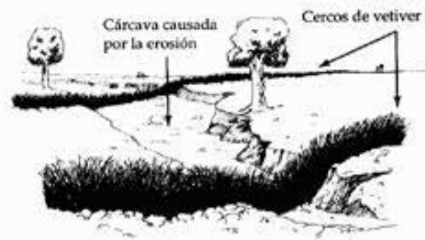
Figura 43. Estabilización de cárcavas
