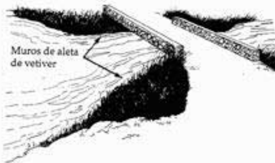
Figura 44. Protección de puentes
