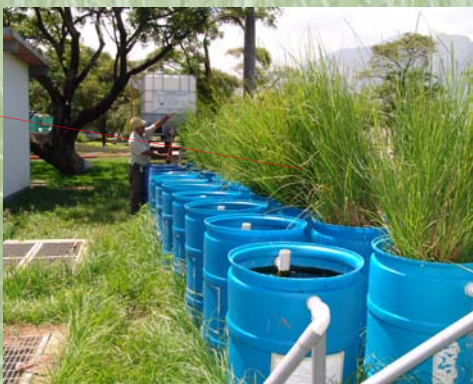
Sistema de Tambores tipo Adic Voca para realizar experimentos con aguas servidas. Cervecería Polar-Planta San Joaquín
