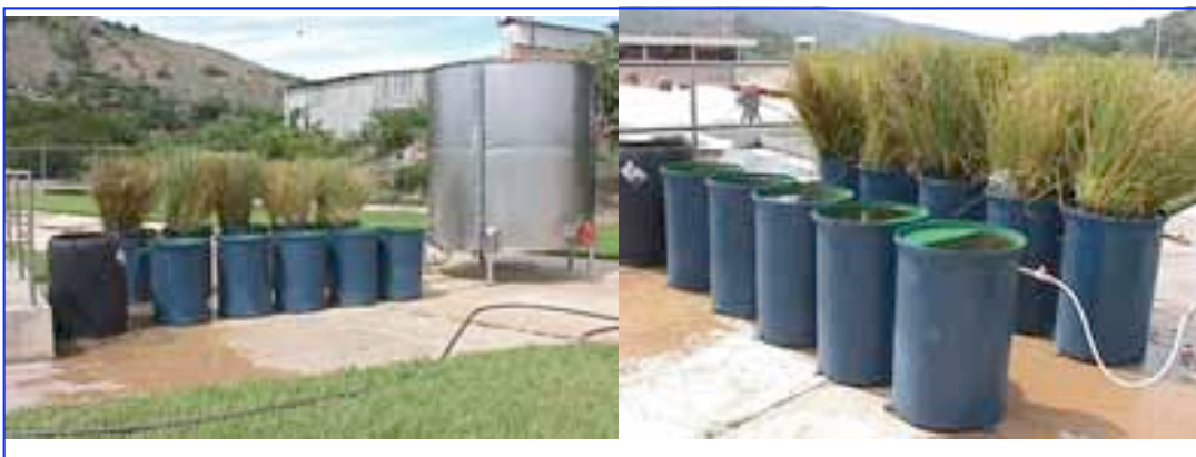
Foto 1. Esquema del sistema de tratamiento de aguas residuales, con pasto vetiver; a pequeña escala, en la Planta de Tratamiento de Aguas Residuales de PepsiCola CA. Modelo ADIC/VOCA modificado ( www.vetiver.org/TVN-bonn03.pdf ).
