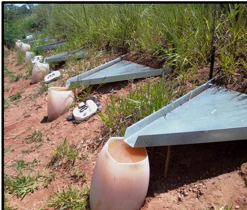
Figura 1. Calhas e bombas (50l) em algumas unidades experimentais, Inconfidentes/MG.
